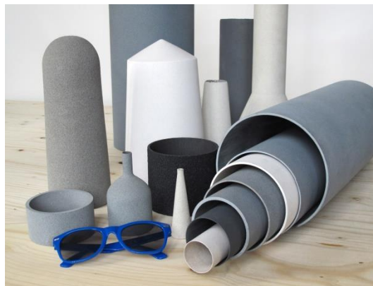
Plazmově stříkané skořepiny připravené na ÚFP AV ČR pomocí technologie WSP-H.
