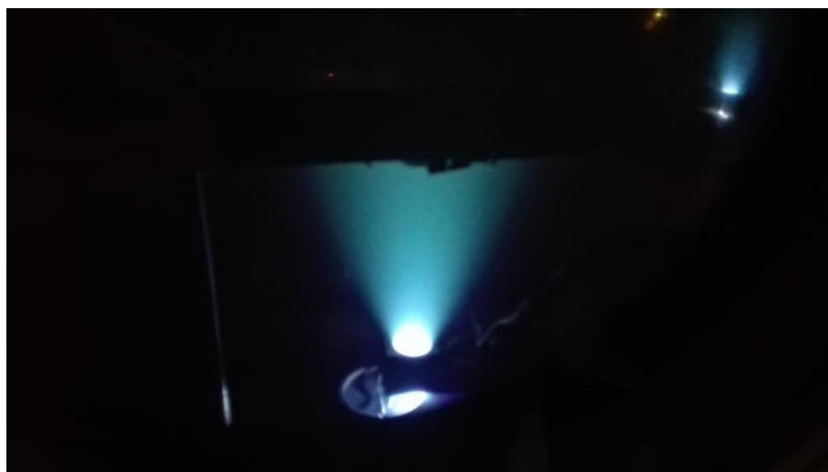
Obrázek 1: Plazma v průletové komoře dopadající na substrát a vytvářející tenkou vrstvu
