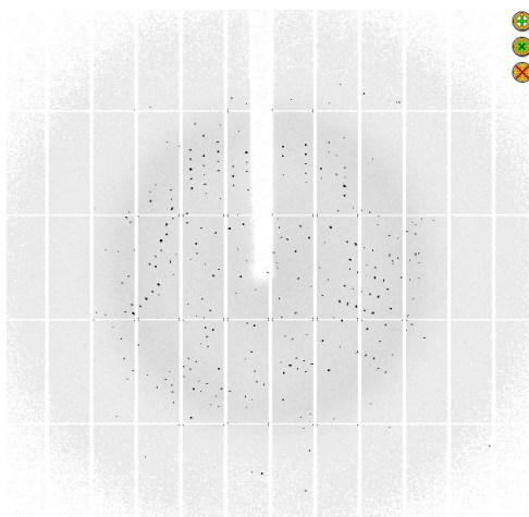
Obrázek 1: Difrakční snímek krystalu MnCO pořízený na synchrotronu Petra III (měřicí stanoviště P13) v Hamburku. Snímek zobrazen pomocí programu iMOSFLM [4].
