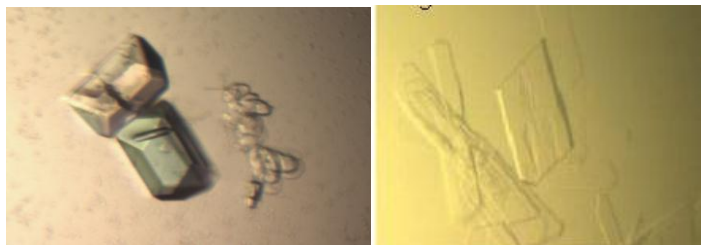
Obr. 1: Krystaly použité pro máčení v roztocích ligandů: a) krystal OPAA, b) krystal \beta -gal.
