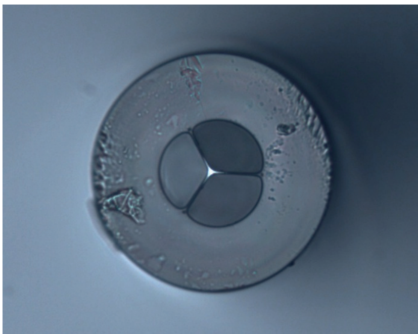
Obrázek 1: Mikrostrukturní optické vlákno se steering wheel strukturou
